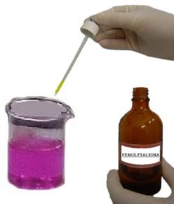
Procediamo dunque con la **titolazione**, aggiungendo l'acido cloridrico nell'idrossido di sodio, e mescolando lentamente la soluzione con un agitatore di vetro. Questo procedimento richiede molta attenzione e precisione: man mano che liberiamo dalla buretta l'acido nel beker sottostante, notiamo che la soluzione si scolora (da viola a incolore). Questo accade perché il grado di basicità diminuisce fino ad arrivare a pH neutro (al cosiddetto **punto di equivalenza**).
